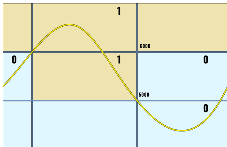
Рисунок 2.10 Преобразование аналогового сигнала в дискретный
